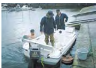
完全に浸水しても沈まない不沈構造を採用しました。写真はそのテスト風景です。
