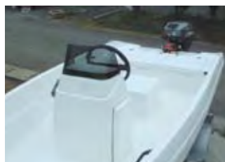
前方が見やすいセンターコンソール仕様。コンソールにも収納スペースを確保しました。
