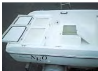
後部右舷側に燃料タンク室。左舷側にバッテリー室。ドライバーシート下にイクスを配備しました。
