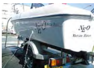
デッキ排水なので、雨や打ち込んでくる波にも安心です。
