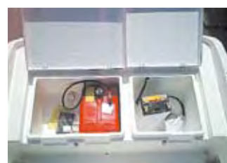
燃料タンク室には 12L タンクを 2 個収納できます。
